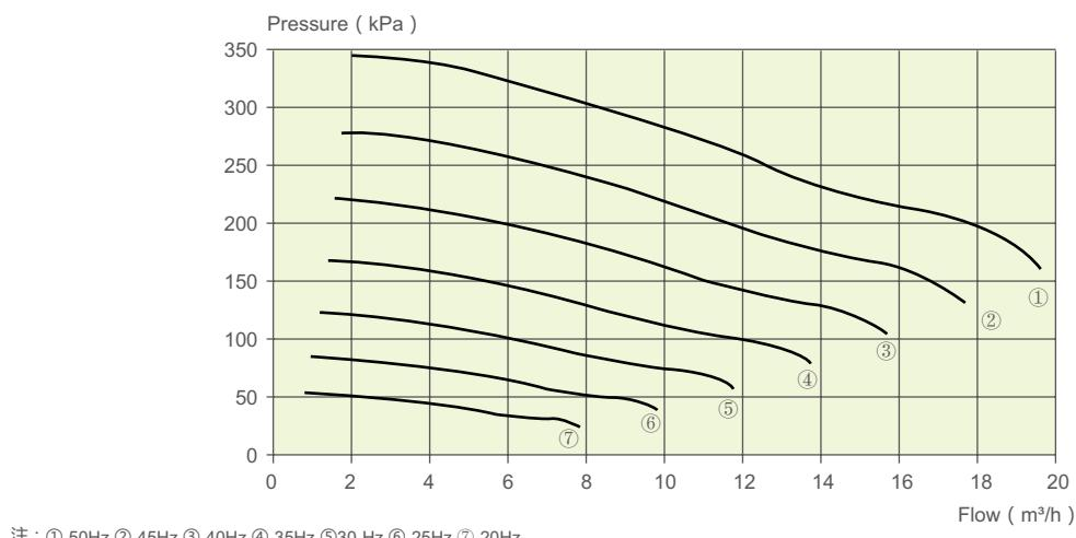
注 : ①-50Hz,②-45Hz,③-40Hz,④-35Hz,⑤30-Hz,⑥-25Hz,⑦-20Hz
