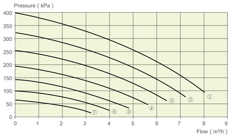
注 : ①-50Hz,②-45Hz,③-40Hz,④-35Hz,⑤30-Hz,⑥-25Hz,⑦-20Hz
