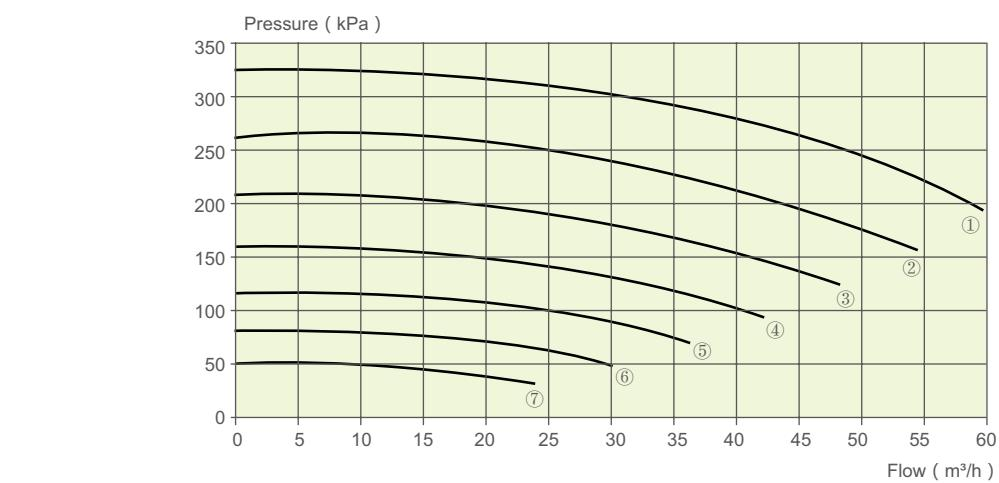
注 : ①-50Hz,②-45Hz,③-40Hz,④-35Hz,⑤30-Hz,⑥-25Hz,⑦-20Hz
