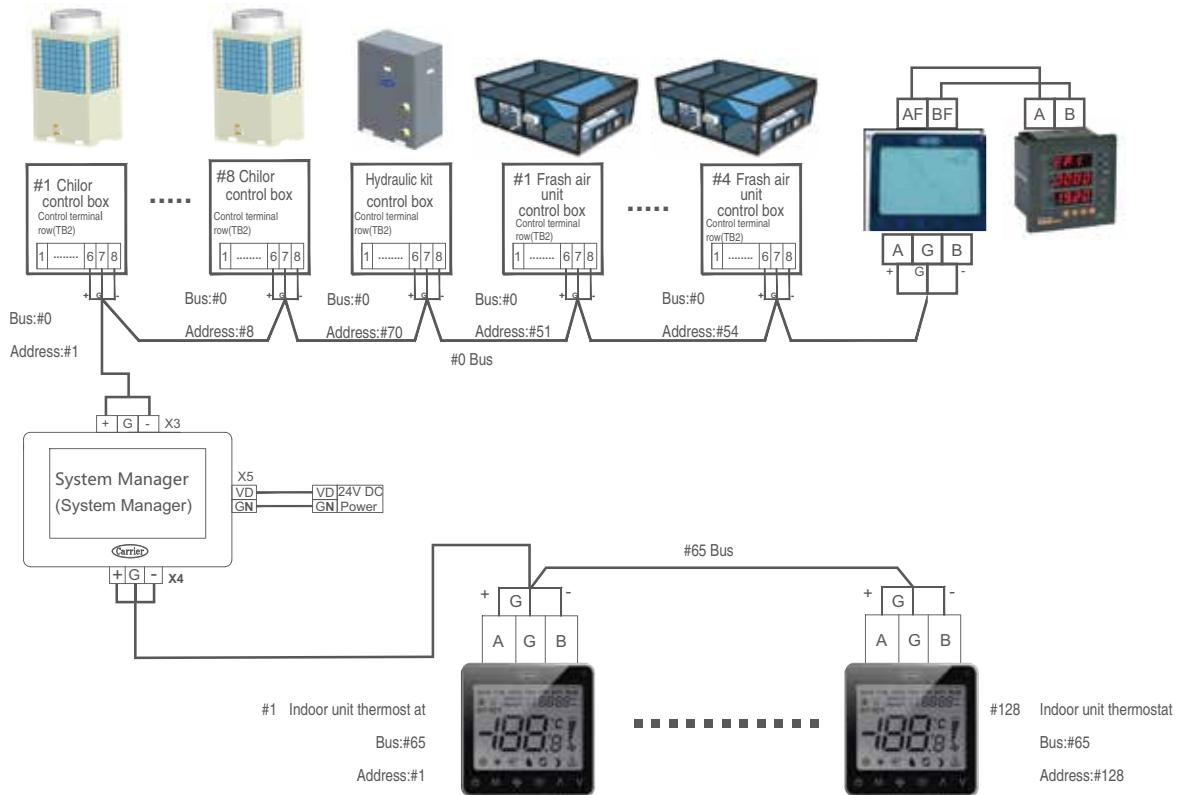
说明：每台室外主机、水力模块、新风机和风机盘管必需单独引接电源，并配置相应的断路开关和过载保护，严禁通过另外一台机组的端子排引接。
