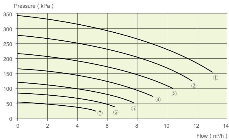
注 : ①-50Hz,②-45Hz,③-40Hz,④-35Hz,⑤30-Hz,⑥-25Hz,⑦-20Hz
