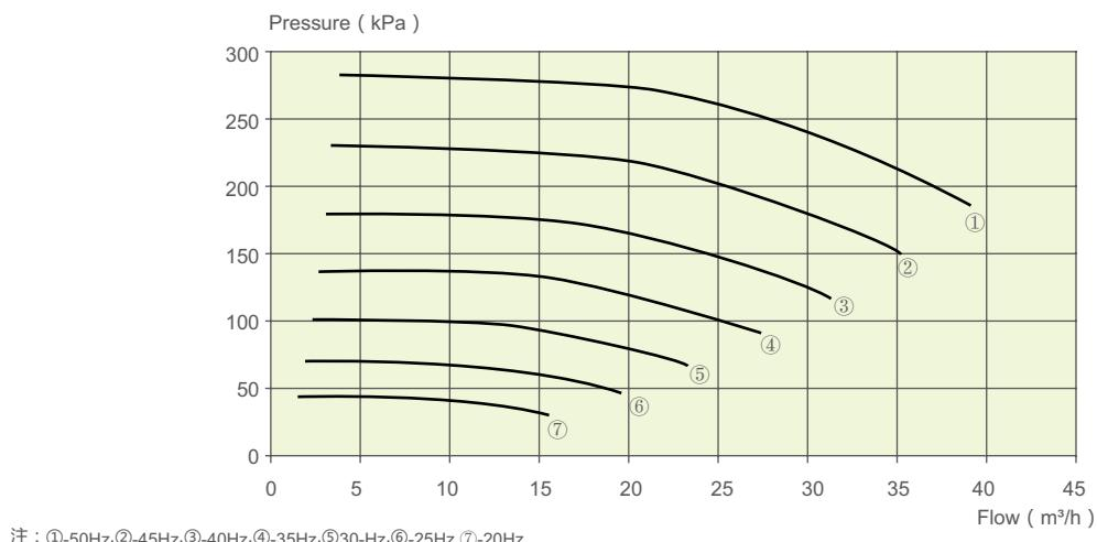
注 : ①-50Hz,②-45Hz,③-40Hz,④-35Hz,⑤30-Hz,⑥-25Hz,⑦-20Hz
