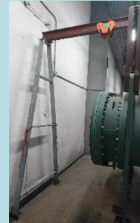
工地發現未能出示有效證書的吊重裝置，被要求即時安排拆卸。
