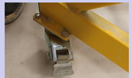
工友使用流動工作台時，未有鎖上所有腳輪輪鎖。現提醒員工在使用流動工作台前，必須檢查並確保所有腳輪輪鎖已鎖上。
