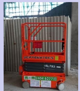
工人正在使用不合規格的工作平台以及未有佩帶安全帽及安全帽繩。發現後即時停止工作並提供安全訓練及較剪式動力工作平台予工人使用。
