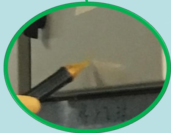
員工使用接地測試筆對設備外殼進行測試時，接地測試筆的筆尖與設備外殼沒有直接接觸，此舉會因測試筆與設備外殼之間的距離太遠，而導致存漏電的情況沒有顯示。有見及此，根據公司最新的指引表示，使用接地測試筆對設備外殼進行測試時，接地測試筆的筆尖必需與設備外殼直接接觸，以避免測試結果出現人為的誤差。
