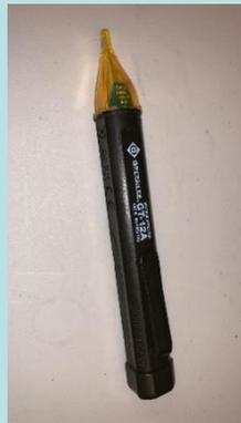
在安全審核中發現仍有分判員工使用不符合公司要求的接地測試筆，現再次提醒各員工，開利香港有限公司對接地測試筆標準之敏感度介乎 **50-1000 VAC CAT IV**，及指定牌子 **GREENLEE**，方為合格
