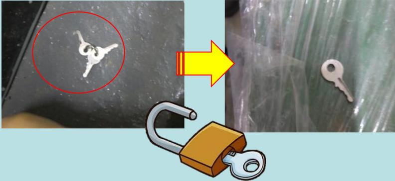
在安全審核中發現技工用作進行電力上鎖掛牌的鎖頭備有3條鎖匙，嚴重違反公司既定的電力安全守則。現提醒所有員工，在進行電力工序時，所有鎖頭均只能配備一條鎖匙，以保障員工的安全
