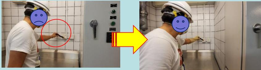
在安全審核中發現員工使用的電動設備連接的漏電斷路器 (G.F.C.I.) 未能符合公司要求10mA 斷電的標準，此舉不但容易因設備漏電而令員工觸電引致嚴重意外，而且嚴重違反公司既定的「開利重要安全規則」。
