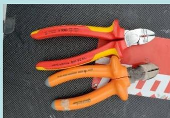
在安全審核中發現員工進行電力工作時沒有使用絕緣手工具，員工容易因導電而觸電受傷。
